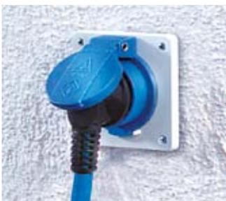
Der Schutzkontakt-Stecker mit kombiniertem deutsch-französischen Schutzkontakt ist um 90 Grad abgewinkelt. Das Kabel steht somit nicht in den Raum und die Wandsteckdose wird entlastet.
