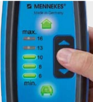
Der Benutzer kann den Ladestrom an die vorhandene Infrastruktur anpassen. So kann der Ladestrom an fremden Steckdosen sicherheitshalber per Taster auf 10A, 8A oder 6A reduziert werden. Der Wert wird automatisch dauerhaft gespeichert.
