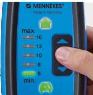
Das mehrstufige Temperaturmanagement verhindert, dass weder das IC-CPD noch die Wandsteckdose zu heiß werden. Bei einem Überschreiten einer Temperatur von 55 °C im IC-CPD oder in der Wandsteckdose wird der Ladestrom automatisch auf 6A reduziert. Sollte die Temperatur weiter steigen, wird der Ladevorgang bei 65 °C unterbrochen und erst dann neu gestartet, wenn die Temperatur unter 45 °C gesunken ist.
